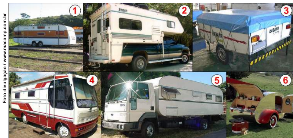
Veículos de recreação (RVs): 1- Trailer; 2- Camper; 3- Carreta-barraca; 4- Motor home; 5- Truck home; 6- Mini-trailer (teardrop)
